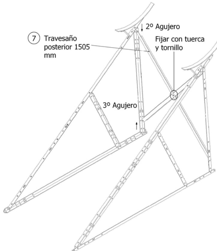
4) Agregar los Ítems 6 a la estructura ensamblada en el paso anterior:
