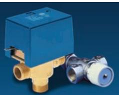
El kit solar se compone de una válvula de 3 vías motorizada y un mezclador termosático. Tiene la función de aprovechar al máximo la energía solar, permitiendo que el equipo de apoyo (caldera, termotanque) solo se habilite cuando el sistema solar no pueda cubrir la demanda deseada. La válvula mezcladora termostatizable, garantiza también evitar la sobretemperatura en los puntos de consumo.
